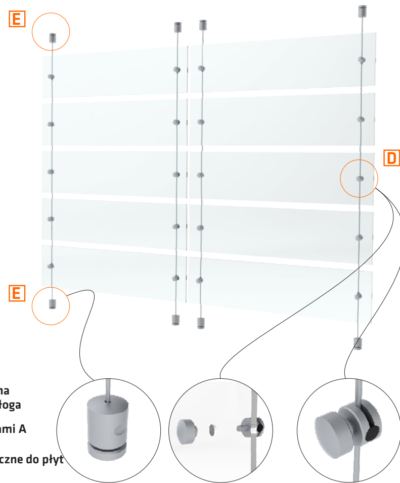
UKŁAD LINKI POD PANELAMI pokazano mocowanie tablicy typu sufit-podłoga
