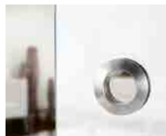
Uchwyt pusty RODNO [uchwyt nierdzewny, średnica 64 mm do szkła grubości 8-13 mm, średnica otworu wierconego 50 mm]*
